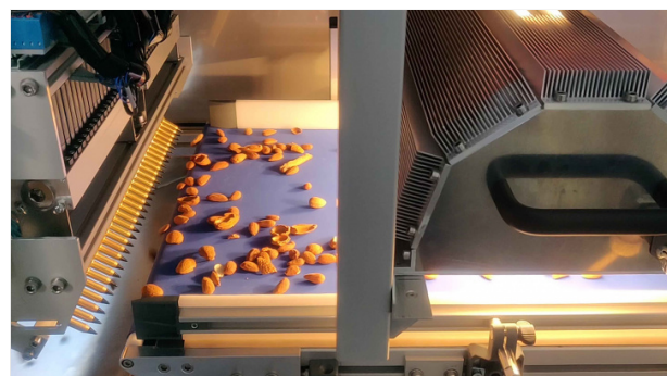
In diesem Beispiel werden Nüsse automatisch von ihren Schalenresten getrennt.
